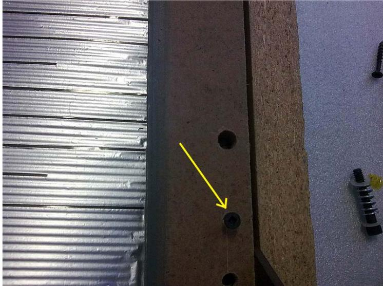
Nun suchen Sie auf der gegenüberliegenden Seite die Löcher für die Befestigung der oberen Leiste und schlagen mit Hilfe des Locheisens genau an dieser Stelle ein Loch in die Folie.
