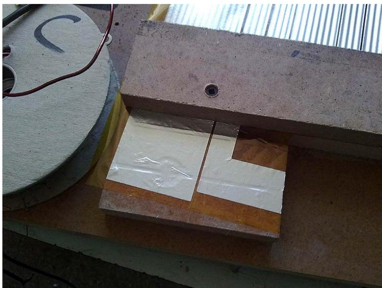
Schneiden Sie jetzt mit dem Cuttermesser ein Loch in die Folie wo sich die Einschlagmutter befindet und tragen eine kleine Menge des mitgelieferten Speziallots auf. Anschließend lassen sie das Lot mit einem LötKolben schmelzen und stellen damit eine sichere Verbindung her.
