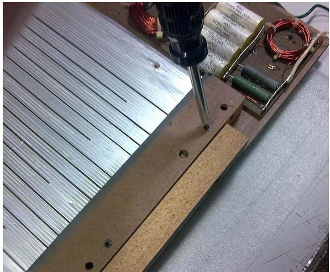
Die seitlichen Leisten sind verklebt. Um die Verklebung zu lösen verwenden Sie einen entsprechend großen Flachsraubendreher und treiben ihn mit vorsichtigen Hammerschlägen zwischen die beiden Leisten. Achten Sie darauf das sie dabei nicht das Holz spalten.
