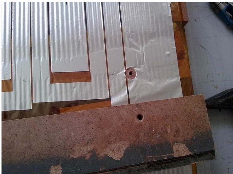
Danach finden Sie noch die jeweils zwei Löcher der oberen und unteren Leiste und schlagen ebenfalls zwei Löcher durch die Folie. Damit ist gewährleistet das Sie am Schluss die Folie spannen können ohne das sie zerreißt.
