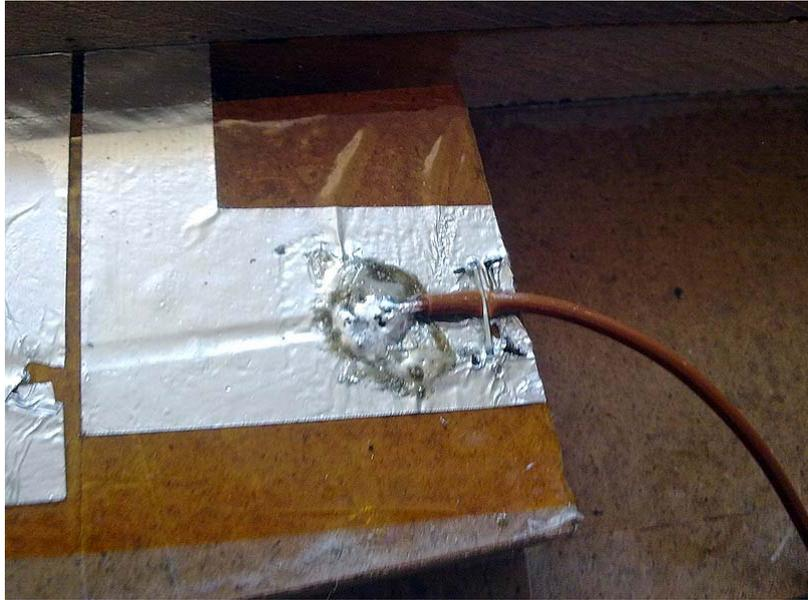
Verbinden Sie das schwarze Massekabel vom Anschlussfeld mit einem geeigneten Kabel ausreichenden Querschnitts und führen beide Kabel zum oberen Anschlusspad. Zum fixieren verwenden Sie Sekundenkleber oder eine andere Befestigungsmöglichkeit Ihrer Wahl.
